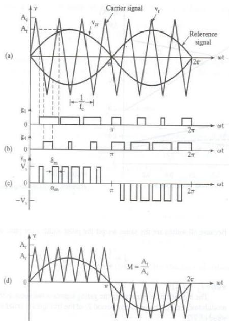
**Figure 5: Sinusoidal PWM**
